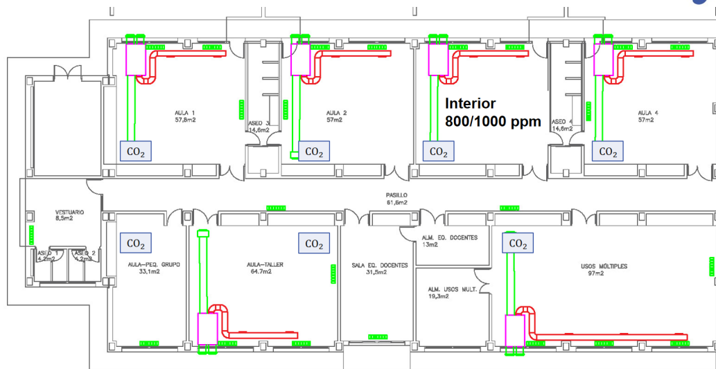
Figura 8. Instalación mecánica de ventilación y recuperador de calor en centros con ventilación natural (Se garantizará una distancia mínima entre las tomas de aspiración y extracción).
